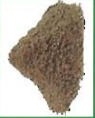
原材料は混合真砂土・色粉・少量の固化材のみ！
